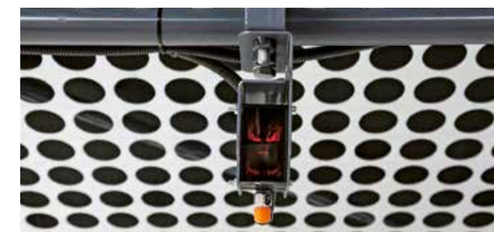
Sistema redundante de tres sensores láser independientes
