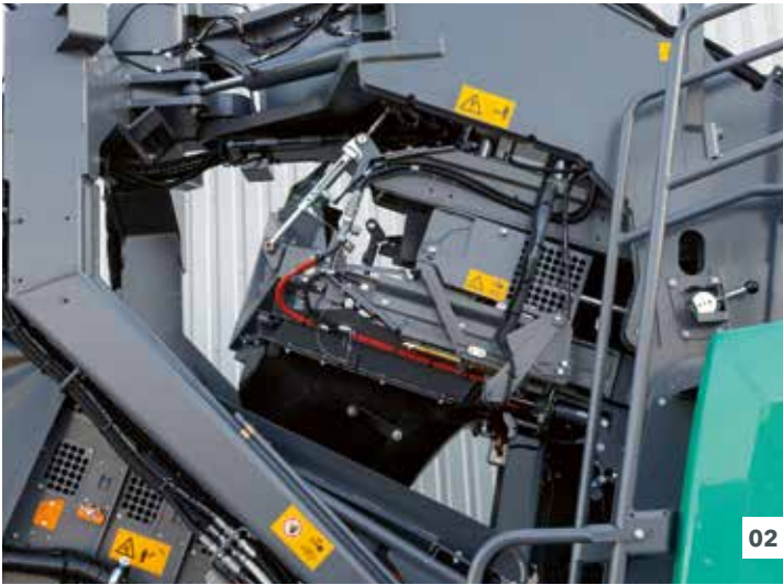
01 Compuertas de mantenimiento de fácil acceso 02 Tolva de transferencia abatible
