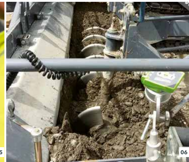
04 Las funciones principales de extendido pueden controlarse utilizando las unidades de mando a distancia bimanuales de la regla. 05 Sistema automático de nivelación Niveltronic Basic. 06 Perfecta calidad de extendido gracias a la perfecta gestión de materiales.
